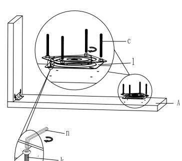
$\label{eq:REVOLVE} \textbf{REVOLVE}(c)\, \textbf{INTO(1)},\, then \,\, fasten\, \textbf{(1)}\, \textbf{TO(A)}\, and\, \textbf{(K)}\, \textbf{BY(n)}.$
